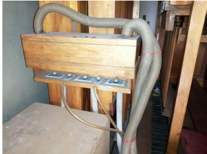
Abb. 5 Pneumatische Register-einschaltung Pedal
