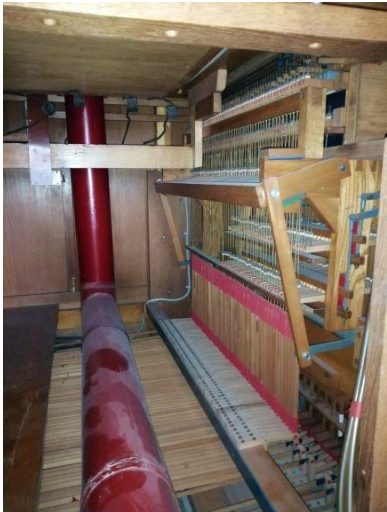
Abb. 4 Spieltraktur und Koppelaufbau
